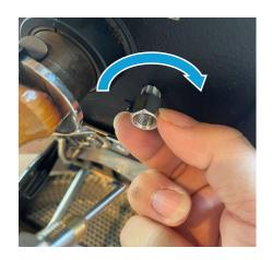
取り外したナットを先ほど 外した穴に差し込みます。 ※合わせづらいですが、はまるように なっているので角度を変えながら 試してみてください。
