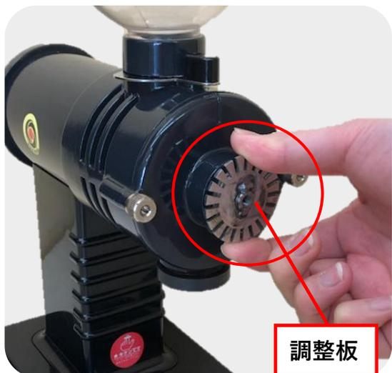
2. 電源スイッチを入れ「調整板」を右方向へゆっくり廻します。途中、金属音が鳴ったらその位置から左方向へ一目盛り戻します。(カット臼の場合は二目盛り)
