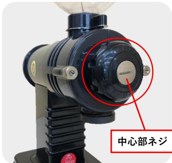
1. コインドライバーやコインを用いてダイヤル中心部のネジを緩め、ダイヤルを取り外します。
