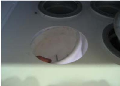
フィルターを下段フタを開けて下側に引抜きます。しっかり入っているので斜めに上から押してください。
