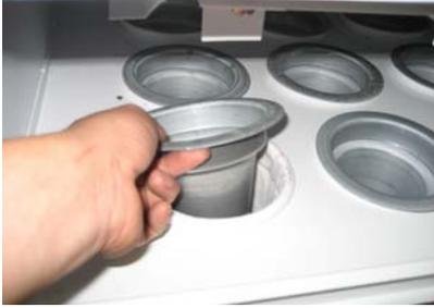
本機中断のフタを開き金属のガイド筒を持上げて抜き取ります。
