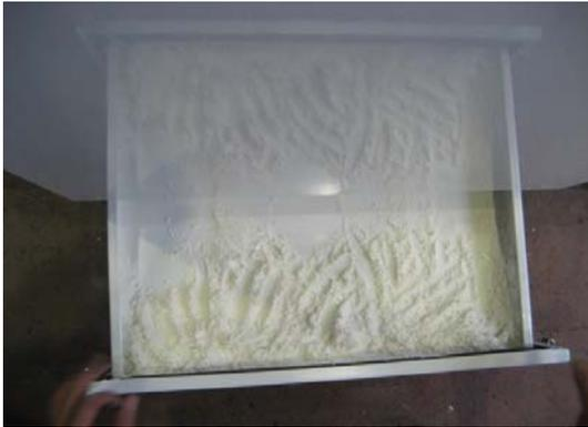
受皿を引き出し、溜まっている粉を手前に寄せ、操作パネルの粉吸口ボタン(ON)を押します。
