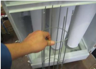
抜き取った金属の筒を新しいフィルターに入れます。
