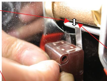
コックと M4×40 ビスの隙間に マイナスドライバーを差込み隙間を拡げるなどの処置が有効です。
