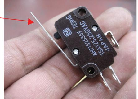
調整バルブが閉の状態でもリミットスイッチも閉の状態でない場合、点火ボタンを押しても点火出来ません。
