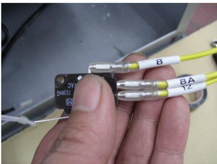
リミットスイッチの線が外れていないか確認する。
