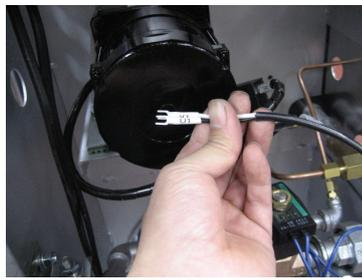
U1、V1の端子をプラスドライバーを使いビスを緩めて下に引き抜きます。(軽く抜けます)
