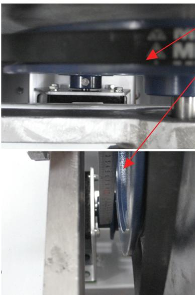
新しいモーターを取付けますシリンダー側のプーリーとモーター側のプーリーの位置が斜めにならない様にボルトを締めます。差しなどをプーリー(本体、シリンダー)当てると良く解ります。
