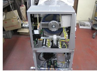
Vベルトをずらして回すとVベルトがはずれます。入れる時はモーター側のプーリーにはめてからシリンダー側のプーリーにはめて回すと入ります。
