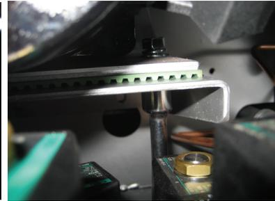
13mmのスパナを使ってボルトナットを抜きます
