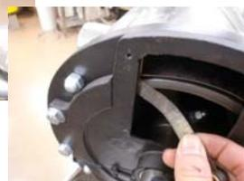
4カ所の隙間が同じ幅になるようにプラスチックハンマーでダイヤル台を叩き調整します。
